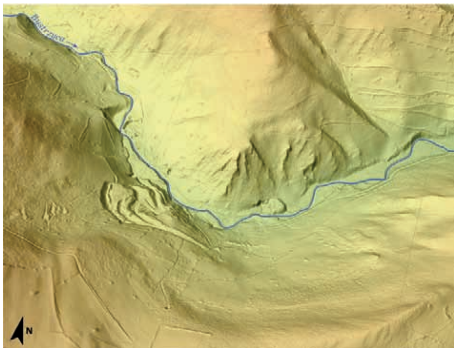
Ryc. 2. Fragment doliny Bystrzycy we wsi Młoty – wizualizacja numerycznego modelu terenu o rozdzielczości 1 m. Uwagę zwracają zarówno progi i ściany skalne na lewym zboczu, jak i znaczne antropogeniczne przekształcenie dna doliny i prawego zbocza.
